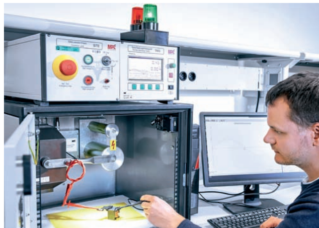
Obr. 4 Zariadenie na testovanie čiastočného výboja: skúška čiastočného výboja sa vykonáva ako typová a rutinná skúška v spoločnosti Phoenix Contact Power Supplies v Paderborne v Nemecku.
