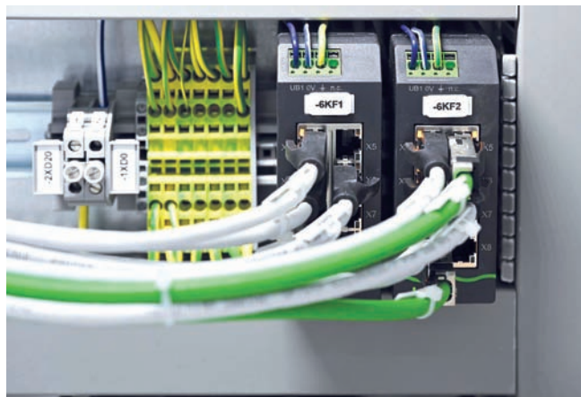
HandlingTech vybavuje svoje štandardné robotické bunky dvomi sieťovými prepínačmi Xelity. (Zdroj: Murrelektronik)
