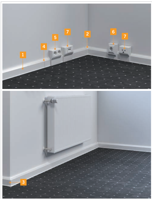
Prehľad systému soklových lišt od spoločnosti OBO Bettermann: 1 – kanál, 2 – vnútorný roh, 3 – vonkajší roh, 4 – spojka hornej časti, 5 – zásuvkový box, 6 – zásuvkový box vrátane krytu, 7 – zásuvkový dátový box
